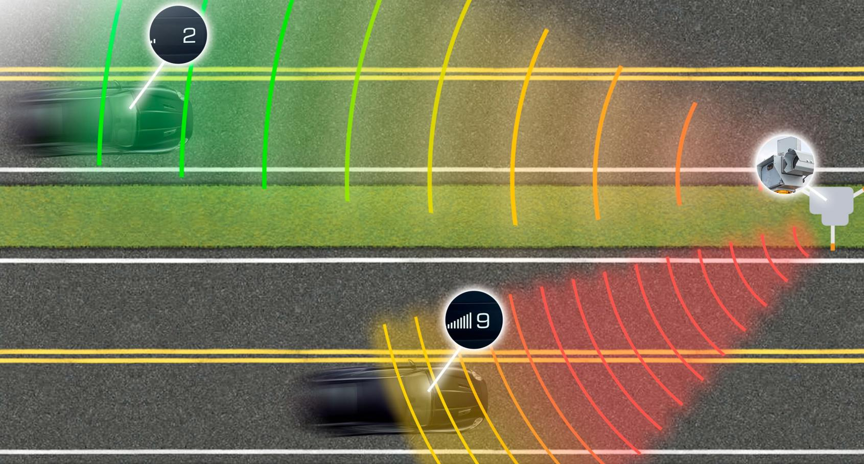
При помощи функции Гейгер-эффект **iBOX Pro 800 Signature X** разделяет радиосигналы на 9 уровней интенсивности и дает графическое представление о силе излучения полицейского радара. Чем ближе радар, тем сильнее излучение и тем длиннее шкала, отображающая уровень сигнала.
